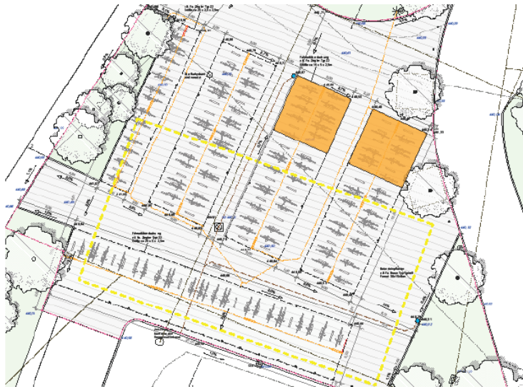
Bild 2: Variante 2: PV-Anlagen auf Teilflächen der Fahrradüberdachung, Flächen für Photovoltaikanlagen sind gelb markiert
