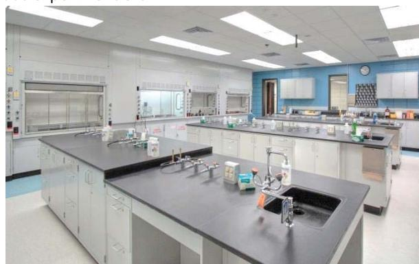
**Abb. 2.3.2.2:** Das Bild zeigt einen Laborraum mit den nötigen Anschlüssen (Gas, Wasser und Strom). An einer Seite befinden sich mehrere Abzüge. Die benötigten Geräte befinden sich in Untertischschränken. Es ist eine Verbindung zur Sammlung und eine zum „normalen“ Unterrichtsraum vorhanden.
